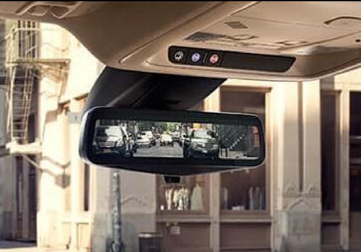
Multi inner mirror (w/DVR function) /流媒体电子后视镜（带行车记录仪功能）
