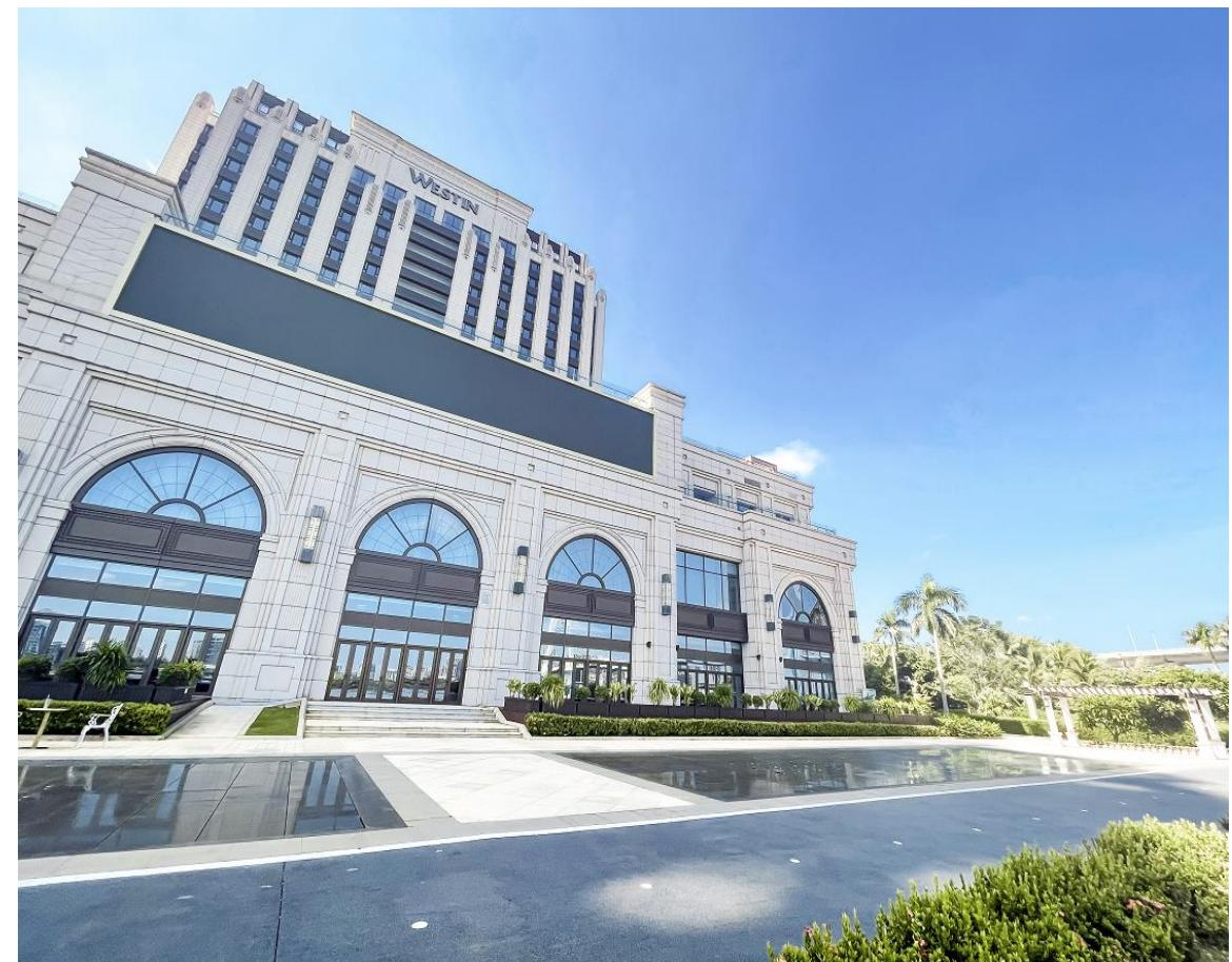
P8户外全彩显示屏，显示面积: 27.6m\*4.6m, 共127平米 (分辨率: 3456点\*576点)
